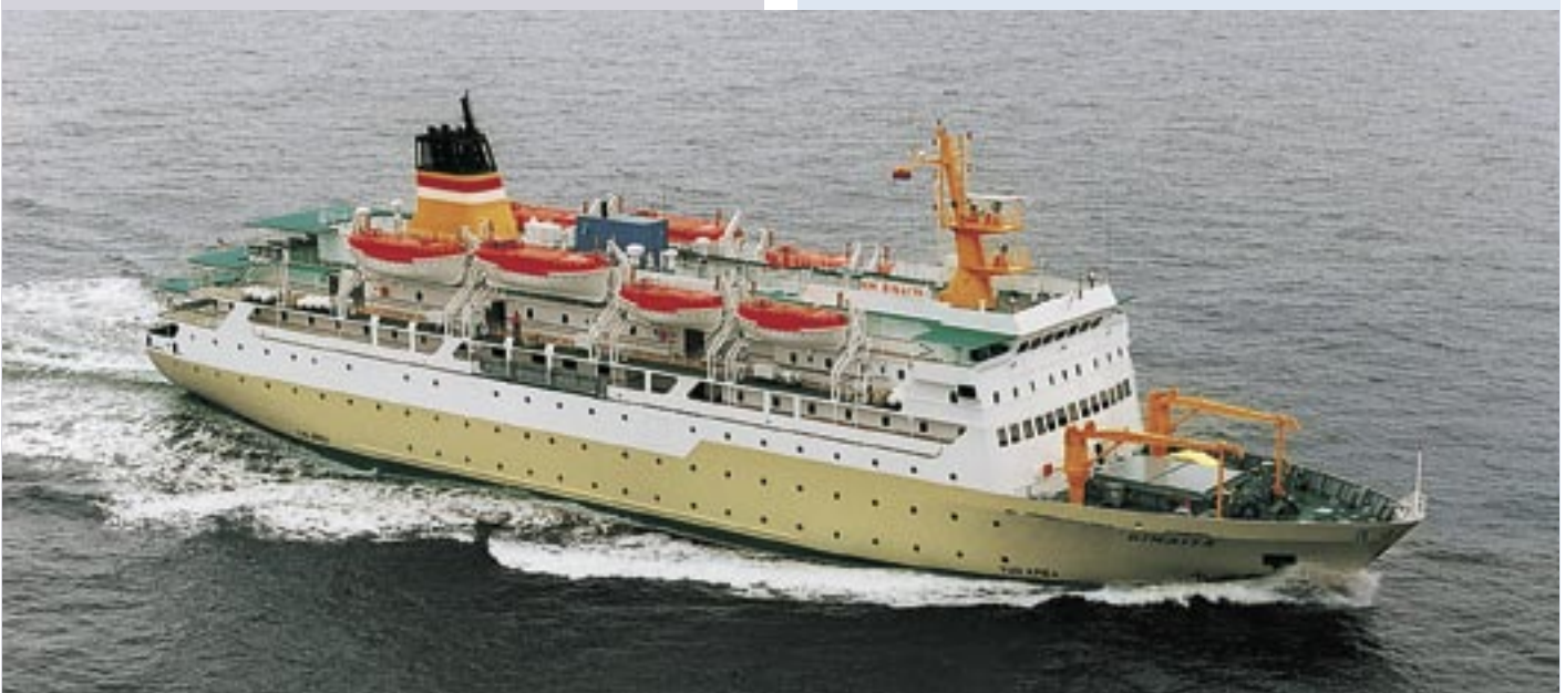
Passagierschiff des Typs 1000 in voller Fahrt. Am Bug des Schiffes erkennt man die Kräne für den zusätzlichen Transport von Gütern.
