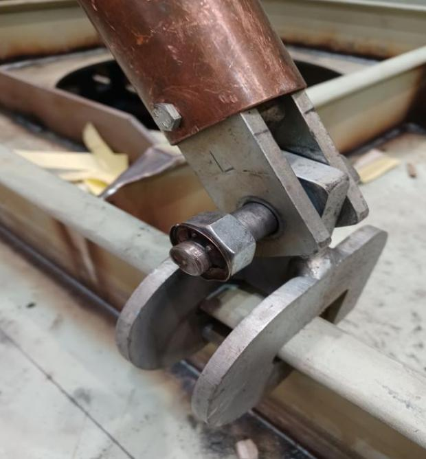
Drehstütze für LW's ( Mit Schweißpunkt )
